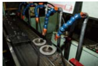
ブロワを利用した斜板ライン
