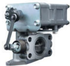
バタフライ式EGRバルブは、流路抵抗及び駆動力が小さいという利点がありながら、全閉時の締め切り性の悪さといった懸念事項により現在まで採用されてきませんでした。今回新概念のシール構造(特許登録番号3726815)を開発することで、日本で初めてバタフライ式EGRバルブを実用化しました。さらにDCモーターと非接触角度センサーを用いたアクチュエーターを採用。大量EGRと精密制御が可能となり、排気規制である新長期規制への対応に大きく貢献しています。
