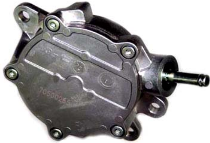
【写真：バキュームポンプ】
