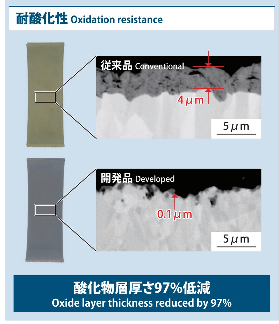
適用例 Application 主軸受、コンロッド軸受
