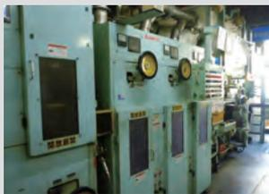
軸受素材の研磨工程
